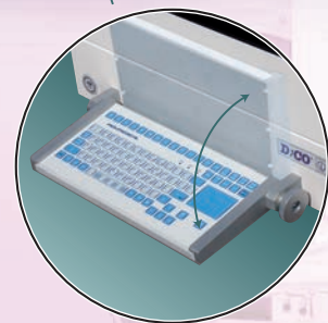
Łatwa do dezynfekcji, składana medyczna klawiatura podfioletowa zintegrowana z touchpad'em, z powłoką antybakteryjną (dostarczana również jako oddzielny wyrób).
